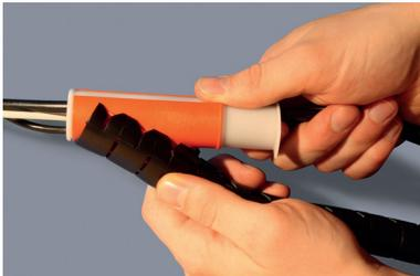
Schutzschlauch am Werkzeugkopf aufstecken.
