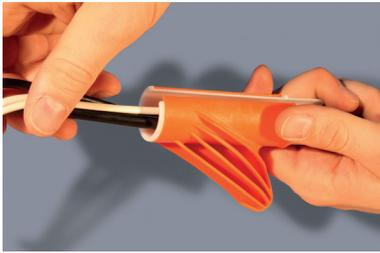
SHR-Schlauch zuschneiden, Werkzeug öffnen und Kabelbündel einlegen.
